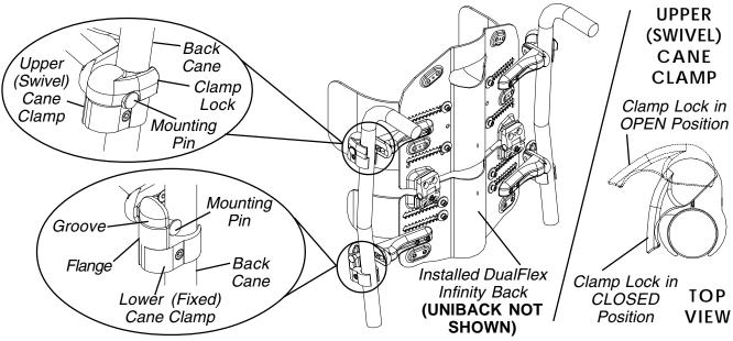
FIGURE 1 - INSTALLING/REMOVING THE INFINITY BACK
